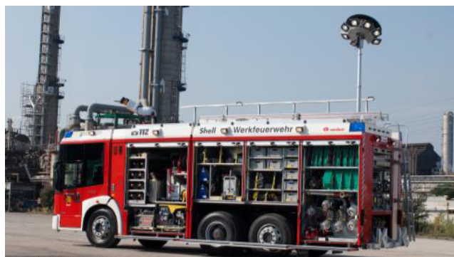
Camión de incendio con un sistema de inyección de espuma Hydromatic y R600
